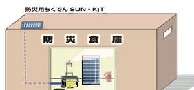
インバーターのリモートスイッチとAC100V電源を室内に引き込みます。スイッチを入れると100V100Wの家電品を約9時間使用することができます。
